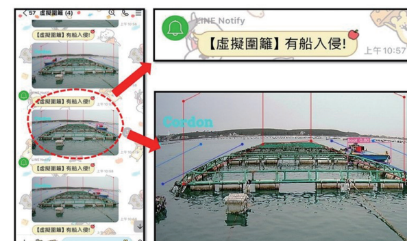
圖 1、海上箱網 AI 虛擬圍籬防盜系統。
