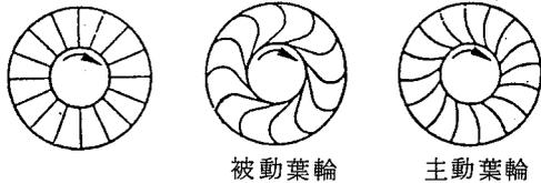
(a) 液體接合器葉輪 (b) 液體扭矩變換器葉輪
